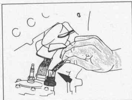
Fig. 43 - Verifica funzionamento elettroventola
